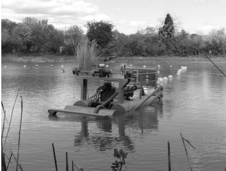
Der KLAWA-Bodenschlammräumer im Einsatz auf dem Eisweiher
